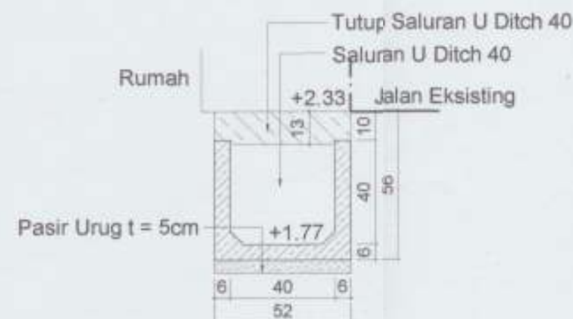
DETAIL SALURAN U DITCH 40 Skala 1 : 20
